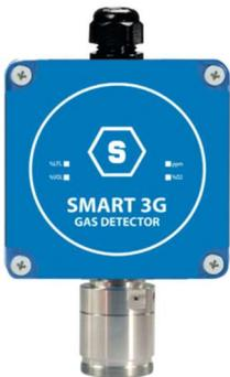
L'elemento sensibile è alloggiato nella testa in acciaio inossidabile. Per la rilevazione di sostanze infiammabili, **gas refrigeranti** e anidride carbonica viene usato il **senso infrarosso**, non suscettibile ad avvelenamenti e con un'elevata selettività.
